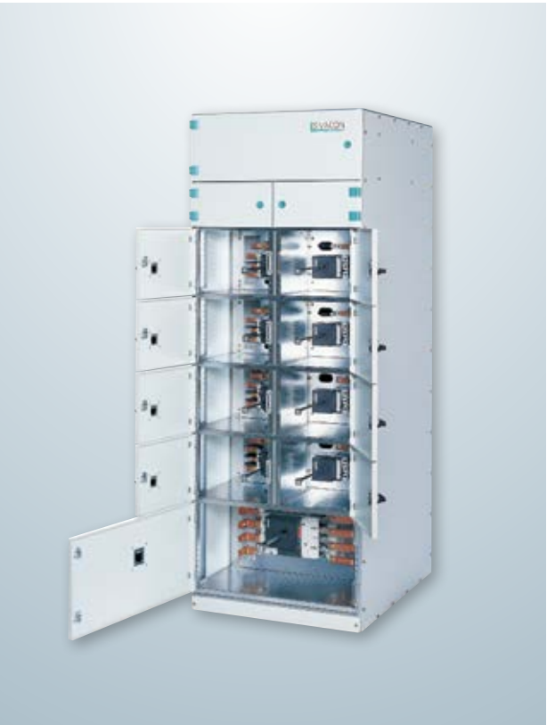
每一功能单元具有连接盒，内部间隔形式最高可至 IEC61439-2 的形式 4 类别 7
