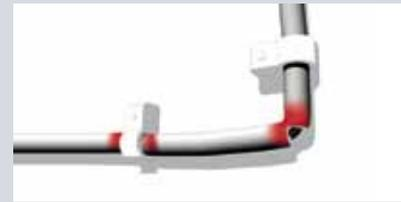
另一个风险源是在安装过程中，由于电缆弯曲半径太小，导致断裂。过于紧固的线夹也会损坏电线绝缘。
