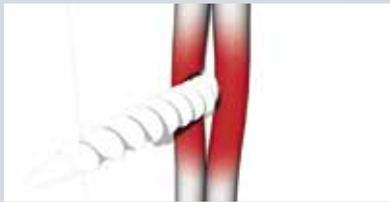
电线绝缘不良（比如由于被钉子和螺丝损坏），会导致绝缘故障。
