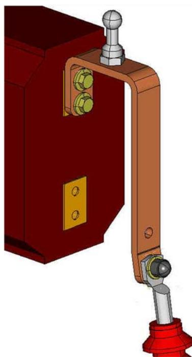
图 42: 上面电缆连接件处的接地螺栓
