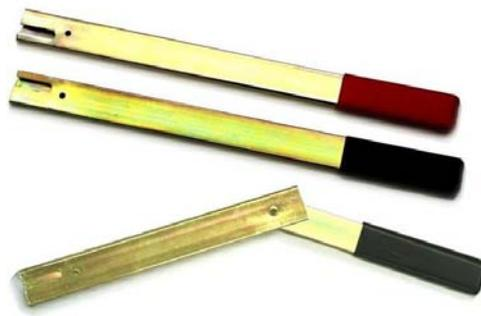
图 56: 带有红色手柄的操作杆用于接地和解除接地，带有黑色手柄的操作杆用于负载分断 / 断路器分断/隔离分断。可选：单杆操作和防反向操作杆（反向分断操作需要重新插入操作杆）
